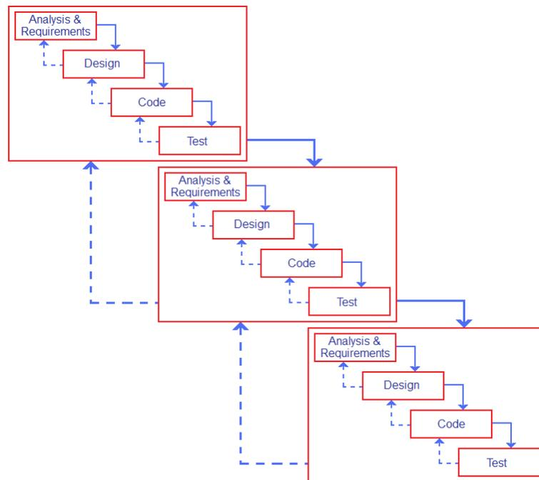
Figure 7 Design-Code-Test iterations (de Weck, & Lyneis 2011)
